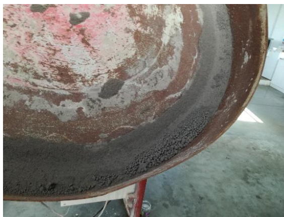
Obrázek 2.: Sbalky připravené mokrým sbalkováním (PS2)
