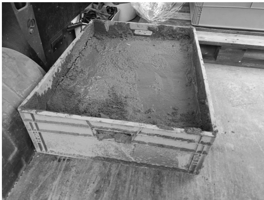
Obr. 1 Zkušební forma s provedeným nástřikem zkušební hmoty
