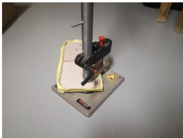
Obrázek 6.: Zařízení pro stanovení odolnosti vůči úderu (REF)
