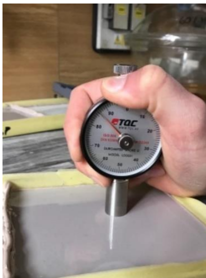
Obrázek 5.: Stanovení povrchové tvrdosti Shore D (PS1 25%)
