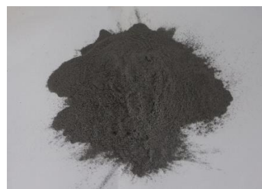
Obrázek 3.: Popílek, používaný při výzkumu upraven přeseťím
