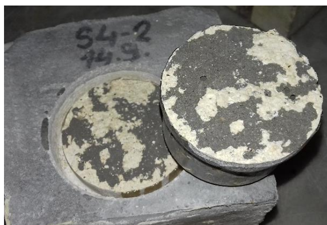
Obrázek 7.: Způsob porušení vzorku S4-2 při zkoušce přídržnosti k podkladu
