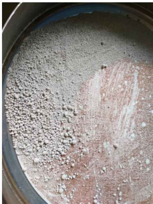
Obrázek 10.: Vytváření "kuliček" z cementářenských odprašků
