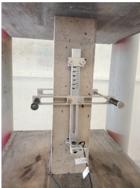
Obrázek 2.: Uložení zkušebního tělesa při zkoušce stanovení statického modulu pružnosti v tlaku
