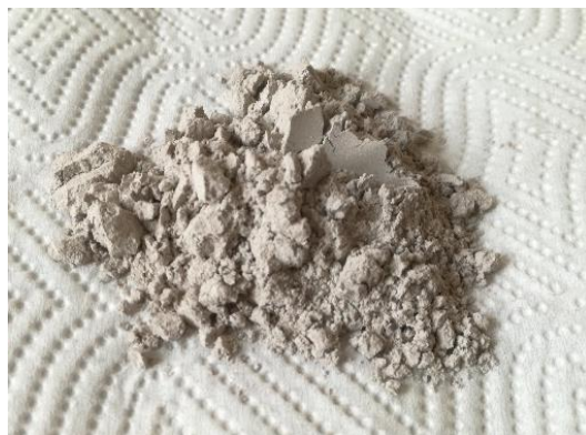
Obrázek 1.: Plnivo připravené suchou homogenizací surovin (PS1)
