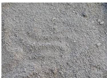
Obrázek 2.: Uložený popílek obsahoval velké množství nečistot (většinou organika) a shluků jednotlivých zrn popílku.
