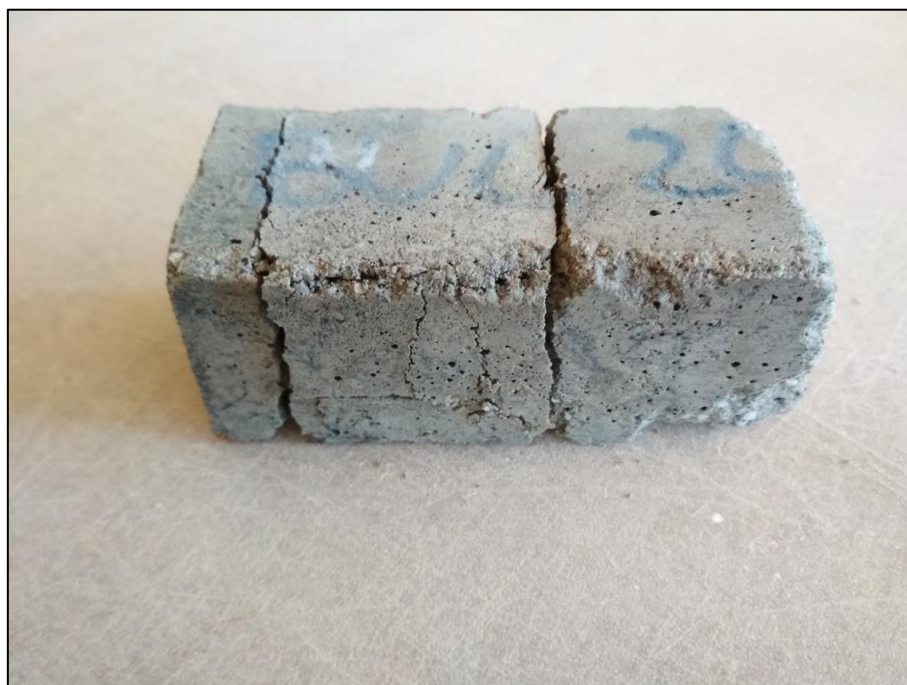
Obrázek 9.: Těleso směsi tvořené 80% popílku po denitrifikaci SNCR a 20% cementářenských odprašků (CKD)
