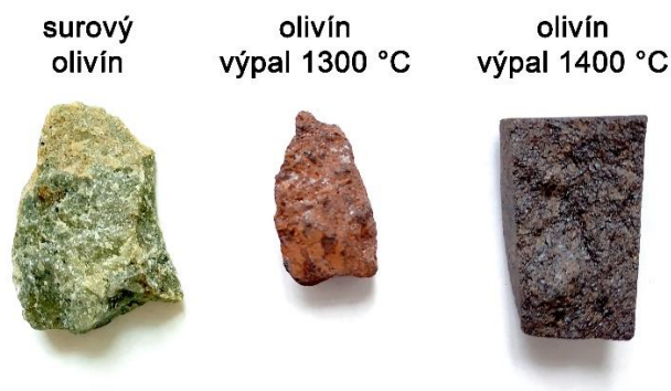
Obrázek 3.: Fotografie olivínu surového a vypáleného při 1300 °C a 1400 °C
