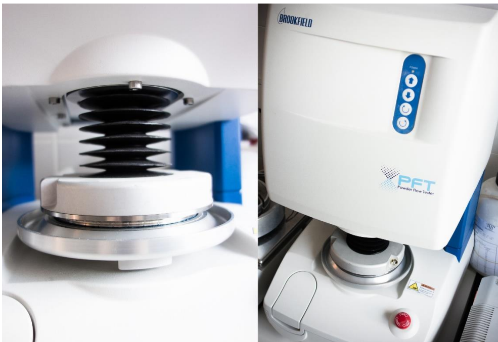
Obrázek 1.: Zařízení PFT Powder Flow Tester, vlevo smyková cela, vpravo celkový pohled
