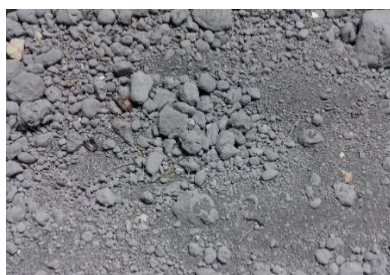
Obrázek 2.: Uložený popílek obsahoval velké množství nečistot (většinou organika) a shluků jednotlivých zrn popílku.
